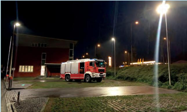
Um eine bessere Ausleuchtung und damit mehr Sicherheit bei nächtliche Einsätze zu gewährleisten, haben wir uns entschlossen eine neue Außenbeleuchtung zu planen und zu errichten. Die niedrigen Parkplatzleuchten wurden durch 3 neue 7m Masten mit je einem 92 Watt LED Flächenstrahler ersetzt, wodurch eine sehr gleichmäßige Ausleuchtung auch für Winterübungen (Dunkelheit schon ab 16.00 Uhr) gewährleistet ist.
