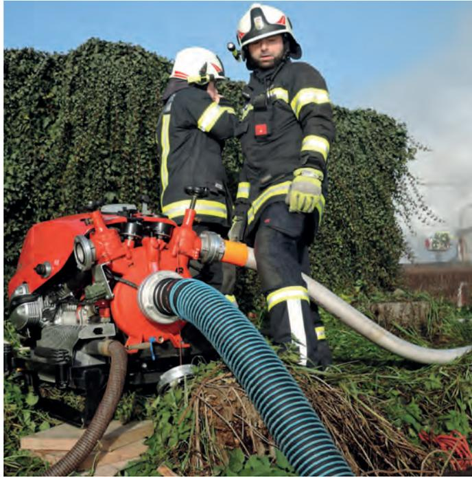
Mit der Tragkraftspritze FOX wurde das benötigte Löschwasser aus der Rodl angesaugt und zum TLF-4000 gefördert.
