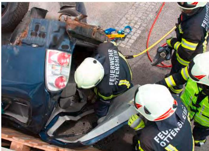
Mit schwerem Gerät wird eine Zugangsöffnung zur verunfallten Person gemacht um diese dann so schonend wie möglich mittels Spineboard aus dem am Dach liegenden Fahrzeug zu retten.
