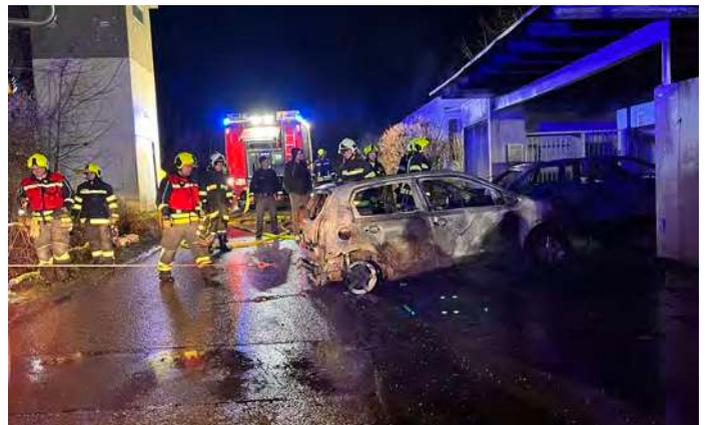
Das Elektrofahrzeug musste anschließend geborgen und in einem Lösch-Container überwacht werden.
